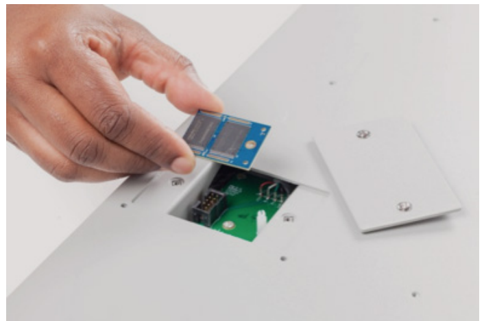
Рисунок 8. Установка «черного ящика» N7908A BBR в источник питания APS
